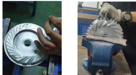
Gambar 3.6 Pembuatan Diffuser Vane.
