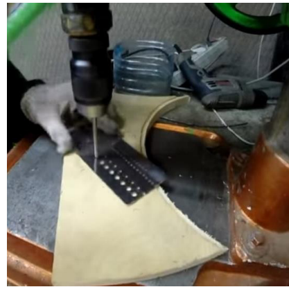
Gambar 3.10 pembuatan lubang celah udara pada ruang pembakaran.
