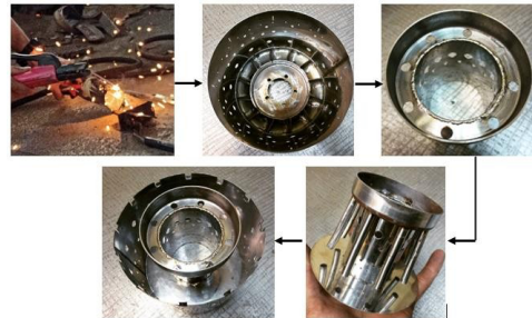
Gambar 3.11 Proses Pengelasan Ruang Pembakaran.
