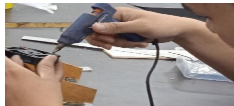
Gambar 2.4 Pemasangan Fan pada acrylic
