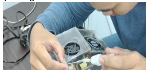
Gambar 2.5 Pemasangan acrylic pada GPU
