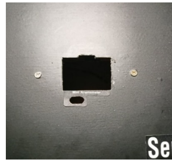
Gambar 3. 17 Pelubangan LCD Anemometer
