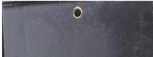
Gambar 19 Lubang \text{Ø}4\text{mm} untuk menempelkan benda uji (Sumber: Doc. Pribadi)
