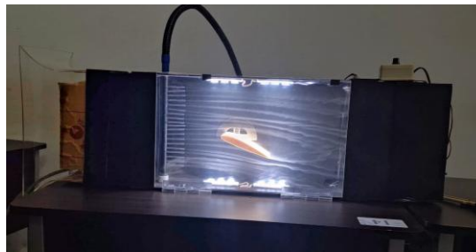
Gambar 31 Tampilan hasil akhir uji coba dari cara kerja smoke tunnel portable . (Sumber: Doc. Pribadi)
