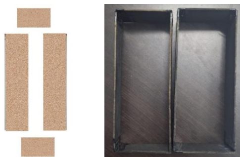
Gambar 14 Potongan karton dmf disusun kotak penghubung (Sumber: Doc. Pribadi)
