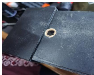
Gambar 18 Lubang \text{Ø}13 mm untuk probe smoke nozzle (Sumber: Doc. Pribadi)
