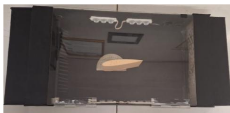
Gambar 27 Pemasangan honeycomb A dan honeycomb B pada test section (Sumber: Doc. Pribadi)
