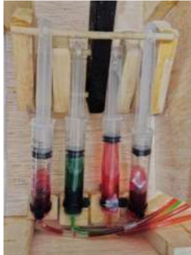
Gambar 7 Pemasangan sistem hidrolik penggerak spoiler [6].
